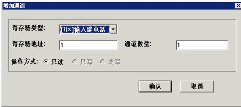
此时可根据需要进行相应寄存器地址通道的添加。例如：要添加 4 区保持寄存器的 40003—40010 共连续 8 个 16 进制有符号 (INT 型)，要求可读可写，则寄存器类型选择 “[4 区]输出寄存器”，数据类型选择 “16 位有符号二进制”，寄存器地址为 3，通道数量为 8，操作方式选择 “读写”，然后点击 “确认” 按钮，即完成通道的添加，添加及添加完成后的内部属性通道如下图所示：
