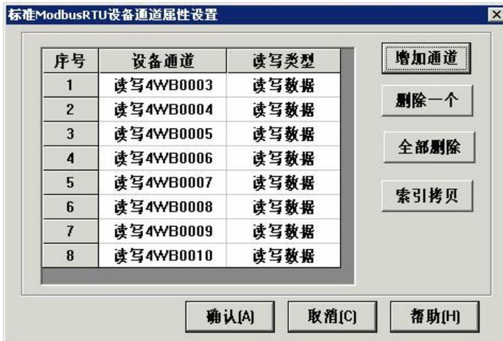
说明：1、MCGS 的 Modbus 驱动在内部属性中添加通道时，寄存器起始地址均为 1，这是遵从 Modbus 协议的，即所谓的“协议地址”，而其实际寄存器地址(即所谓的“PLC 地址”)则为协议地址减 1,也就是说：以协议地址方式添加的地址为 1 时，实际寄存器地址为 0。而对于部分设备描述中，当寄存器地址表中寄存器起始地址为 0 时 (PLC 地址方式)，在使用 MCGS 进行内部属性通道添加或设备命令操作时，地址应转换为协议地址方式，即寄存器地址应加 1 处理。
