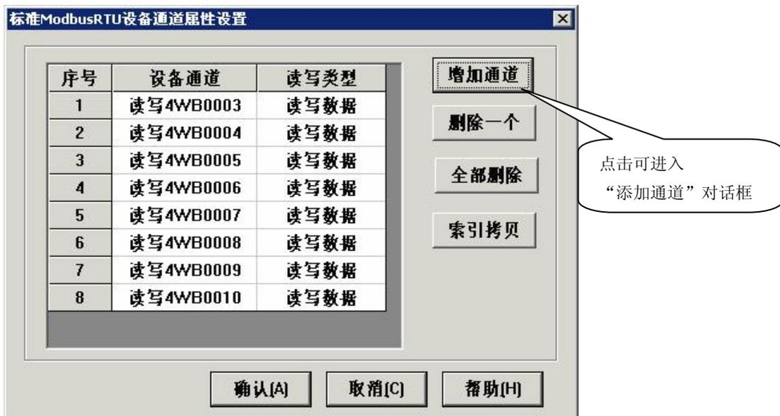
驱动默认添加了 10001—10008 共 8 个只读通道，此时，可利用右侧按钮进行通道的添加和删除操作。当点击“增加通道”按钮，同弹出“增加通道”对话框：
