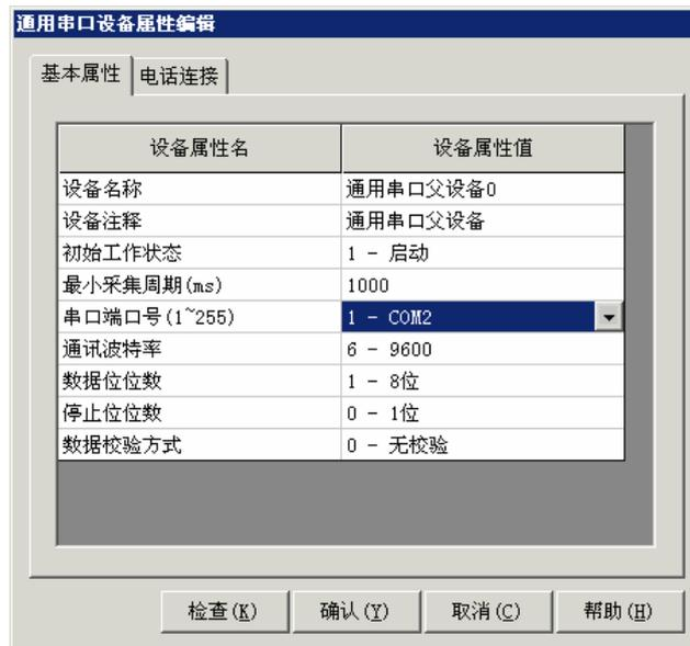
在“通用串口父设备”的基本属性页中，设置了串口通讯参数，包括串口端口号、通讯波特率、数据位位数、停止位位数、数据校验方式等，具体设置参数项如下：
